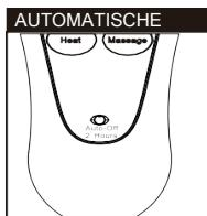
Die automatische Ausschaltfunktion 'Auto-Off' ist in der Steuerung des Kissen integriert. Durch das automatische Ausschalten nach 2 Stunden ununterbrochener Nutzung wird das Sparen von Energie ermöglicht. Die Massagefunktion wird bereits nach 15 Minuten ununterbrochener Nutzung automatisch ausgeschaltet. WICHTIG: nach dem Trennen vom Netz wird die Zeitsteuerung für das automatische Ausschalten automatisch zurückgesetzt.
