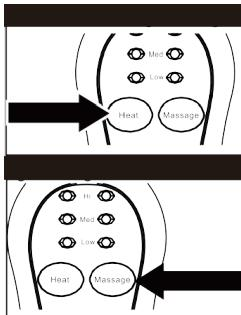
Om de functie 'warmte' toe te passen, schakelt u de schakelaar aan de achterkant van de bediening in, drukt u op de knop 'HEAT' en selecteert u een gewenste temperatuur: HI, MED of LOW
