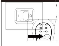
Actionnez le commutateur à l'arrière du panneau de commande et sélectionnez la fonction de chauffage ou de massage désirée à l'avant du panneau. **IMPORTANT:** si les indicateurs de chaleur ne s'allument pas ou restent allumés, débranchez le coussin de la prise de courant.
