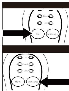
Wenn Sie die Massage funktion aktivieren möchten, dann schalten Sie den Schalter auf der Rückseite der Bedieneinheit ein, drücken Sie dann auf den Massageaktivierungsknopf und wählen Sie anschließend die gewünschte Geschwindigkeit aus:
