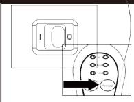
Schalten Sie den Schalter auf der Rückseite der Bedieneinheit ein und wählen Sie dann die gewünschte Wärme oder Massagefunktion auf der Vorderseite der Bedieneinheit aus.
