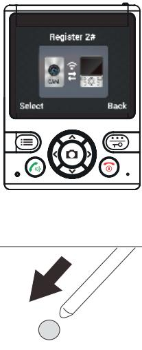
7. Die Innen- und Außeneinheit suchen sich jetzt gegenseitig, die Registrierung ist erfolgreich, sobald die Inneneinheit das Bild der Außeneinheit anzeigt; die Nummer der Außeneinheit wird in der Mitte im oberen Display angezeigt.
