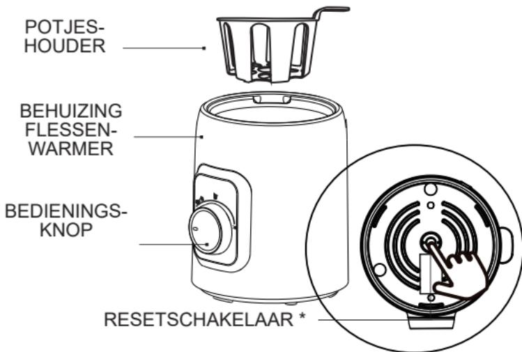
\* De resetschakelaar wordt gebruikt om de stroom uit te schakelen om oververhitting te voorkomen wanneer het water opdroogt.
