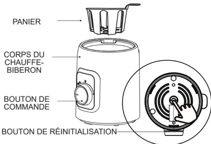
Le **bouton de réinitialisation** permet d'éteindre l'appareil pour prévenir la surchauffe de l'appareil en cas de manque d'eau. Attendez 10 minutes ou versez de l'eau froide dans le chauffe-biberon pour le refroidir, puis appuyez sur le bouton de réinitialisation (jusqu'à ce que vous entendiez un clic) pour remettre l'appareil en marche. Sélectionnez ensuite la fonction nécessaire pour réchauffer les aliments pour bébé.
