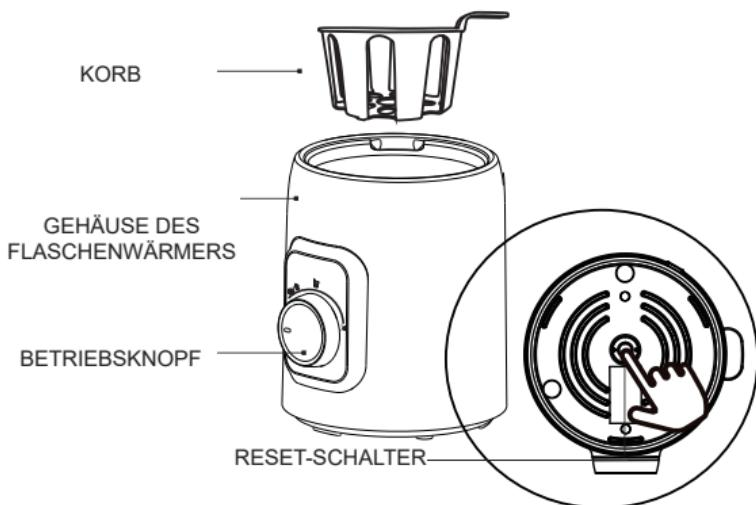
Der **Reset-Schalter** dient zum Abschalten des Geräts nach dem Verdunsten des Wassers, um eine Überhitzung zu vermeiden. Warten Sie 10 Minuten, bis der Flaschenwärmer abkühlt oder gießen Sie kaltes Wasser hinein und drücken Sie dann den Reset-Schalter (bis Sie ein Klickgeräusch hören), um das Gerät wieder einzuschalten. Wählen Sie dann die gewünschte Funktion zum Aufwärmen der Babynahrung.
