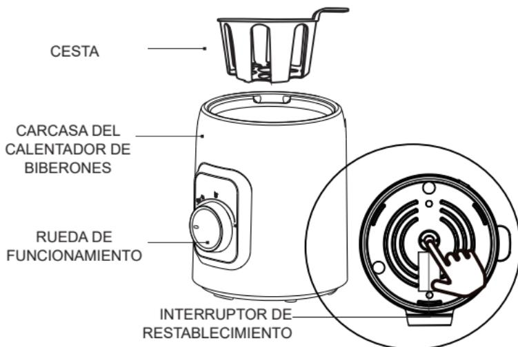
El **interruptor de restablecimiento** se usa para apagar la alimentación para evitar que se sobrecaliente cuando se seca el agua. Espere 10 minutos o vierta agua fría en el calentador de biberones para enfriarlo y, a continuación, pulse el interruptor de restablecimiento (hasta que escuche un chasquido) para volver a encenderlo. A continuación, seleccione la función que necesite para calentar la comida para el bebé.
