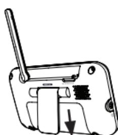
Deslice la tapa de la batería hacia abajo en la parte trasera e inserte la batería suministrada.
