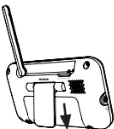
Fai scorrere il coperchio della batteria sul retro verso il basso e inserire la batteria fornita.
