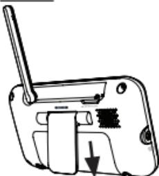
Schieben Sie die Akkuabdeckung auf der Rückseite nach unten und setzen Sie den mitgelieferten Akku ein.
