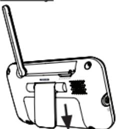
Schuif de batterijdeksel aan de achterzijde naar onder en plaats de meegeleverde accu.
