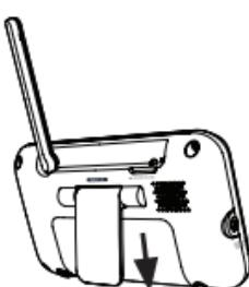
Faites glisser le couvercle de la batterie vers l'arrière et insérez la batterie fournie.
