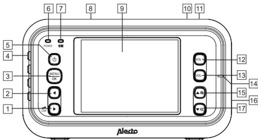
1. im Menümodus zum Scrollen der Setup-Optionen / im Zoommodus: gedrückt halten, um die Ansicht nach rechts zu verschieben / für Multi-Kamera: zur nächsten Kamera wechseln
