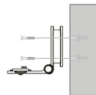
4. Setzen Sie die Kameraeinheit auf die Wandhalterung und schieben Sie sie nach vorne, bis sie einrastet. Schließen Sie den Netzadapter an die Kameraeinheit und eine Stromquelle an.
