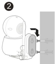
5. Sie können den Blickwinkel Ihrer Kameraeinheit maximieren, indem Sie die Wandhalterung neigen. Halten Sie die Kameraeinheit und drehen Sie den Drehknopf gegen den Uhrzeigersinn. Kippen Sie die Kameraeinheit nach oben oder unten, um den gewünschten Winkel einzustellen. Drehen Sie dann den Knopf im Uhrzeigersinn, um das Gelenk zu verriegeln und den Winkel zu fixieren.
