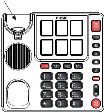
3. haka fast telefonen med skruvhålen över skruvarna och tryck den nedåt
