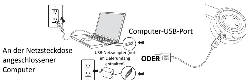
1. Schließen Sie den microUSB-Stecker des Ladekabels am microUSB-Port des Kopfhörers an.
