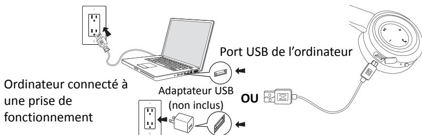
1. Connectez la prise micro USB du câble de charge au port micro USB du casque.
