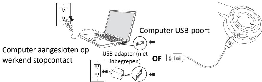
1. Sluit de micro-USB-stekker van de oplaadkabel aan op de micro-USB-poort van de hoofdtelefoon.
