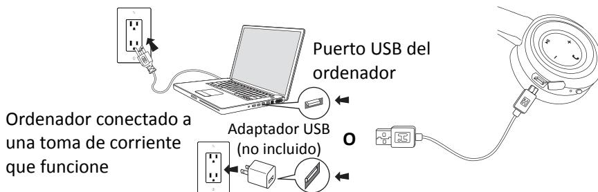
1. Conecte el enchufe micro USB del cable de carga al puerto micro USB de los auriculares.
