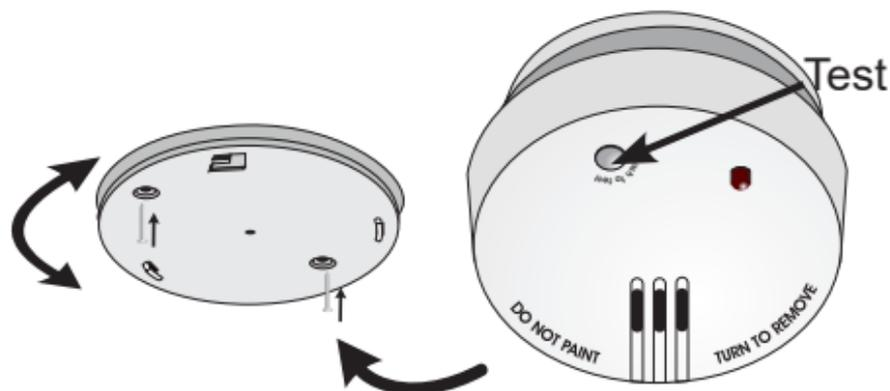
**Pruebas:** Al pulsar el boton de prueba en la SA-100 durante 2 segundos, si el detector funciona correctamente, parpadea el LED y se oye la alarma de 85dB. Pruebe el detector con cigarrillos, llamas o similares.
