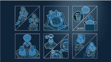
1. Drücken Sie die Entriegelungstasten und nehmen Sie den Scherkopf ab. 2. Drehen Sie die Ringe gegen den Uhrzeigersinn und
