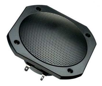
Seewasserbeständiger 10 cm (4") Breitbandlautsprecher mit Glasfasermembran, Kunststoffkorb und Kunststoffgitter. Ausgeglichener Frequenzgang, hoher Wirkungsgrad und gute Mittel-Hochtonwiedergabe. Durch dauerhafte Wetterfestigkeit besonders geeignet für Außenbeschallungsanlagen, Schwimmbäder, Saunen und als Einbaulautsprecher für Boote, Schiffe und offene Fahrzeuge. Auch als Einbaulautsprecher für Schiffs- und Bootsmodelle.
